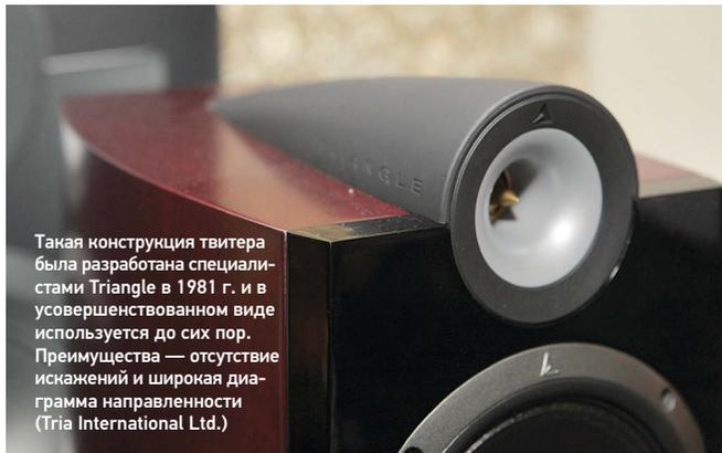
Такая конструкция твитера была разработана специалистами Triangle в 1981 г. и в усовершенствованном виде используется до сих пор. Преимущества — отсутствие искажений и широкая диаграмма направленности (Tria International Ltd.)
